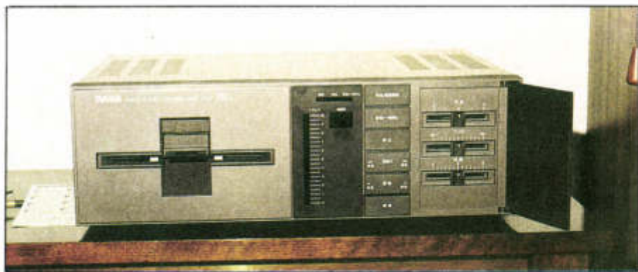
Ce lecteur de disquettes permet ensuite au piano de jouer tout seul
